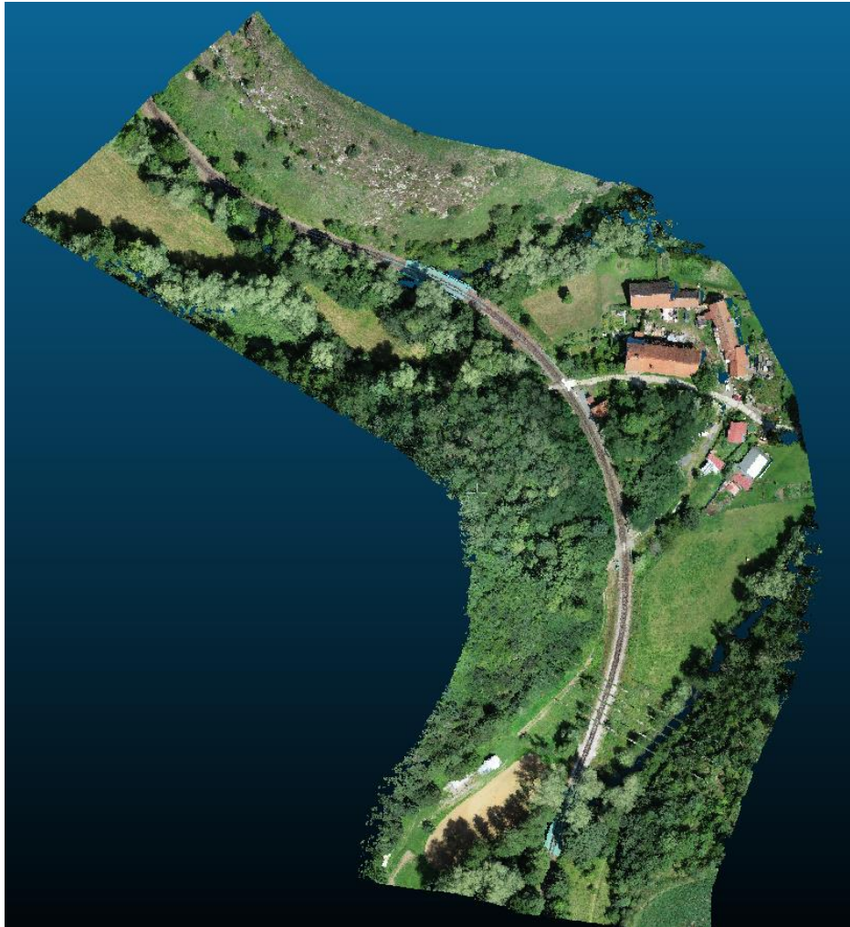
Obrázek 13: Ukázka surových mračen bodů pořízených přístrojem DJI Zenmuse L1
