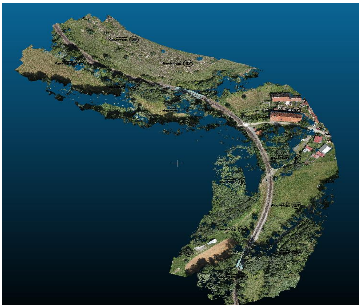
Obrázek 12: Ukázka surových mračen bodů pořízených přístrojem DJI Zenmuse P1
